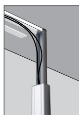
"placer la goulotte et tirer les câbles"
